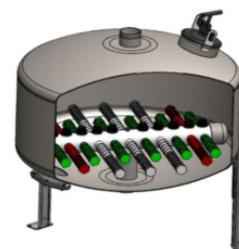
El diseño de drenaje inferior moldeado por inyección cubre todo el diámetro del tanque
