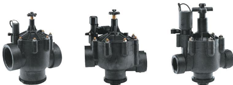
La serie Irritrol100® (Century PLUS) es un excelente ejemplo de una buena válvula mejorada. Ofrece 2 configuraciones: globo ángulo con tamaños que van de una a tres pulgadas, la Serie 100 presenta un rango de presión de 10- 200 psi, regulación de presión modular opcional, medición de acero inoxidable, purga interna y externa, un diafragma de doble reborde Buna- N reforzado con nylon y un diseño anticontaminación para aplicaciones de agua sucia (disponible en todos los Modelos 102).
