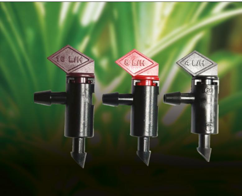
El **Gotero E-2** se puede utilizar en terrenos planos con trayectorias de mangueras cortas en aplicaciones agrícolas, de jardinería e invernaderos. Es igualmente útil para germinar semillas y regar plántulas con una distribución precisa de agua. La amplitud de su laberinto proporciona mayor resistencia al taponamiento. Además, el **Gotero E-2** es desarmable lo cual facilita su limpieza y mantenimiento.
