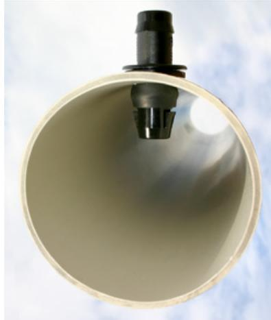
La instalación del conector Xpando® Take-Off se realiza insertando el sello de refuerzo en la tubería de PVC o de Polietileno de alta densidad (HDPE), para después embonar la lengüeta abatible dentro del Sello. La lengüeta se abate al momento de entrar, sin dañar el sello.
