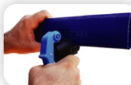
1 Perfore la manguera plana con el punzón correspondiente en la posición deseada.
