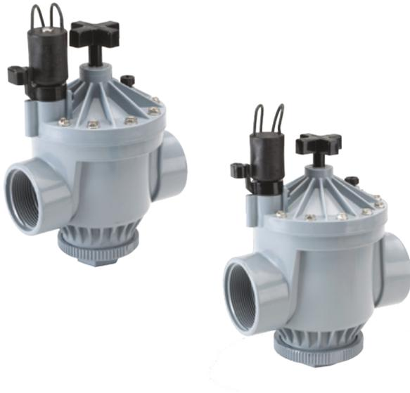
Las válvulas de PVC A-216B de 1½" y A-217B de 2" han ganado popularidad por una trayectoria comprobada de confiabilidad en aplicaciones agrícolas y de invernadero. Sus características principales incluyen control de caudal, purga manual y conexión para uso en configuraciones esféricas y angulares. Estas válvulas versátiles son ideales para una amplia gama de aplicaciones agrícolas.
